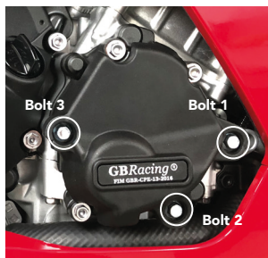
Bolt 3 M6X35HHF - 10Nm
