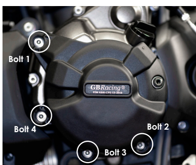
Bolt 4 M6X50A2 - 10Nm
