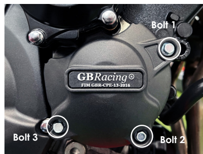
Bolt 3 SPB-2 M6X30HHF - 10Nm
