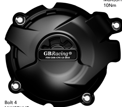
Bolt 3 M6X35HHF - 10Nm
