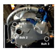
M6x35 - 10Nm Bolt 2 M6x35 - 10Nm
