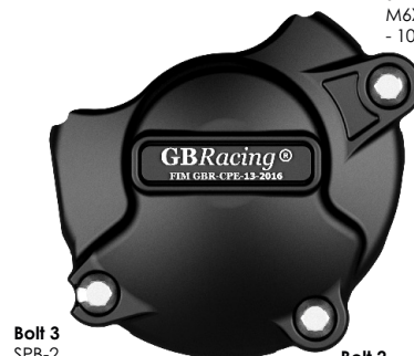
Bolt 2 SPB-2 M6X30HHF - 10Nm
