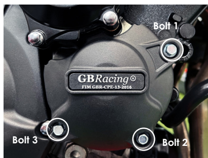
Bolt 3 SPB-2 M6X30HHF - 10Nm
